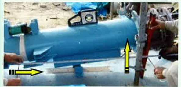
40mmの軸方向変位 8°の屈曲
